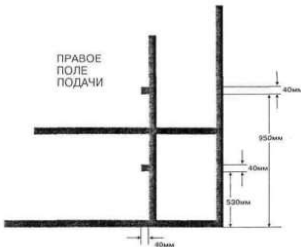
Рис. 2. Контрольные метки для тестирования воланов
